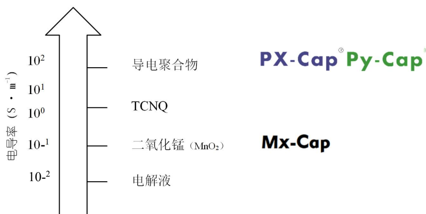
图 2. 典型电容器电解质电导率图
